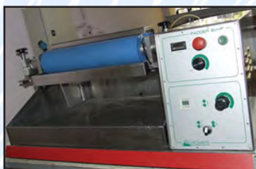
Fig. 31. Fulard pentru impregnarea materialelor textile cu substante polimerice si de functionalizare (ROACHES, Anglia)
