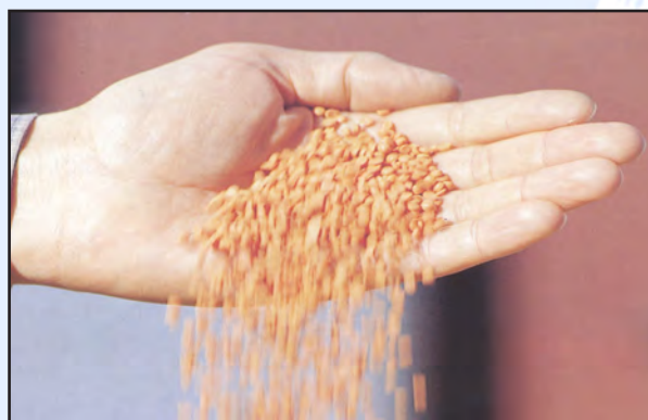
Fig. 109. Nanocompozite polimerice PE/PE-g-MA/EPDM/nanoZnO/TiO 2 vulcanizate dinamic cu sulf si acceleratori
