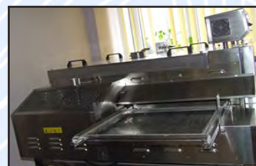
Fig. 32. Aparat de uscare termofixare-condensare-vaporizare pentru operatii intermediare si finale de finisare superioara, ROACHES, Anglia)
