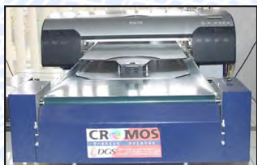
Fig. 33. Echipament pentru imprimare textila digitala cu jet de cerneala (DGS, Italia)
