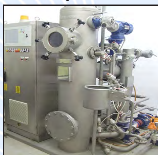
Fig. 36. Aparat de vopsire la T.I. tip jet pentru pregatirea si vopsirea materialelor textile in funie (SCHOLL-THEN, Germania)
