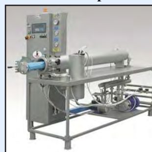
Fig. 37. Aparat de vopsire la T.I. pentru pregatirea si vopsirea materialelor textile in foaie lata (UGOLINI, Italia)
