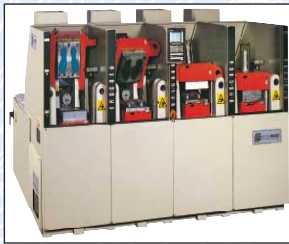
Fig. 104. Masina de injectie
