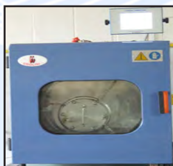
Fig. 34. Aparat de vopsire la T.I. pentru pregatirea si vopsirea materialelor textile (UGOLINI, Italia)
